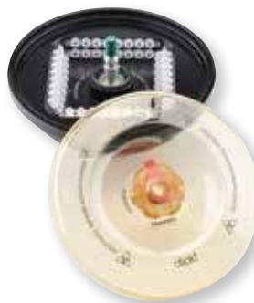
Ротор на 8 × 8 ПЦР пробирок
