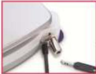
**Гнездо для защитного устройства**
