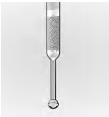
Высокотемпературная каталитическая трубка сжигания
