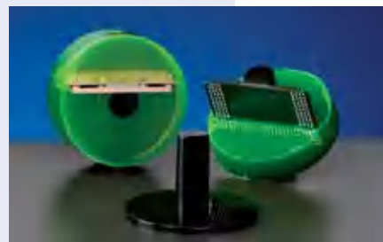
Вставка для формочек диам. 40 мм (05756912), для заливки полностью и частично
