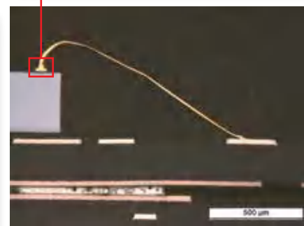
Обзор и детализация, диаметр золотого провода 20 мкм
