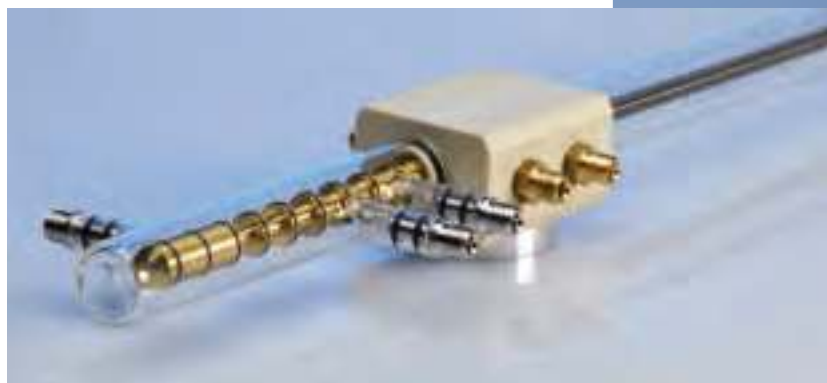
Уникальное автоматическое устройство для калибровки анализатора по 10 объемам (не требует применения стандартных образцов)
