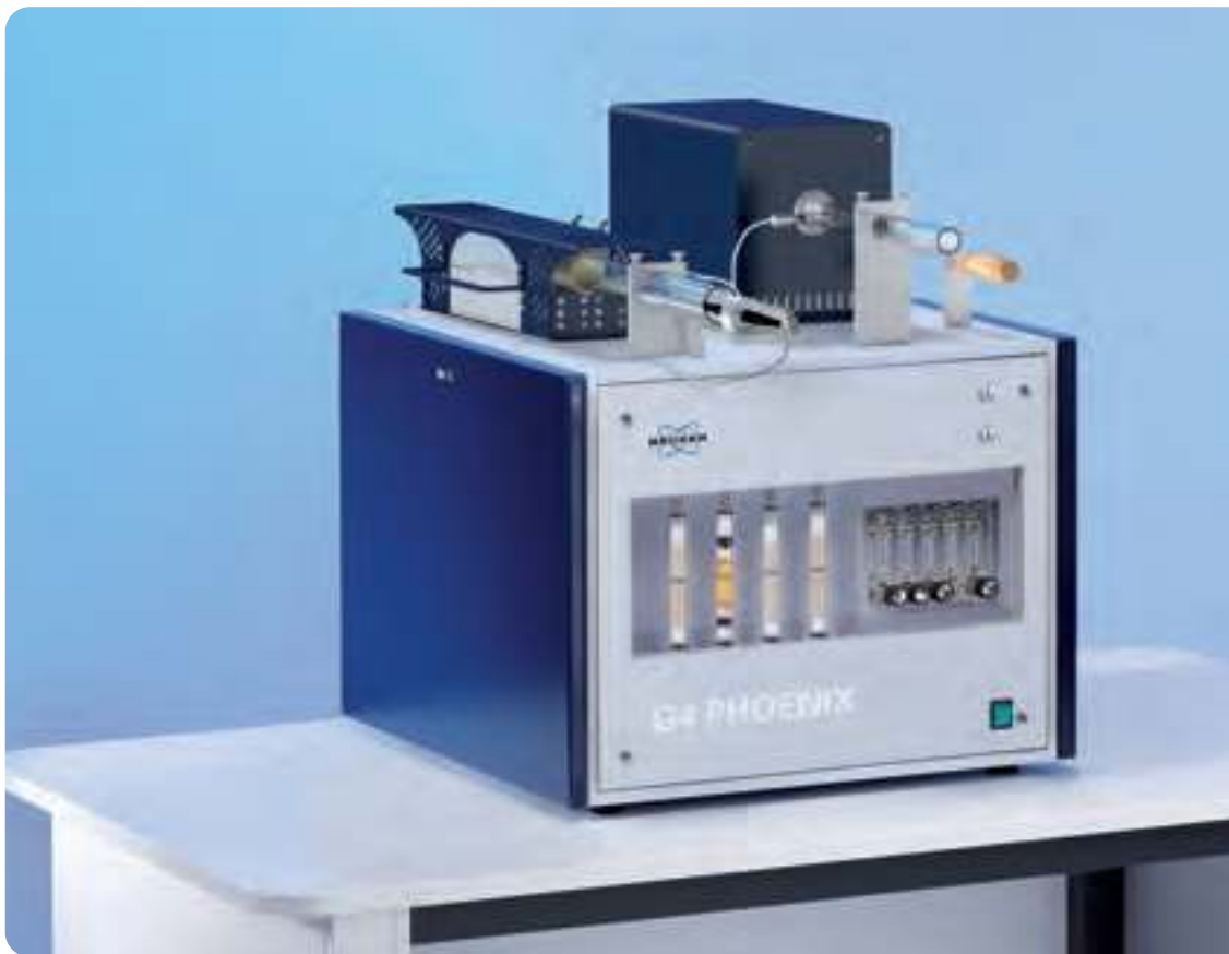
G4 PHOENIX с ИК печью (≥ 900 °C) и печью сопротивления (≥ 1100 °C)
