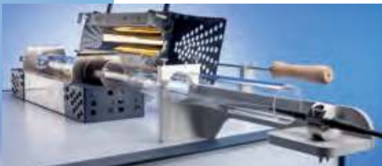
ИК печь с термопарой для точного измерения фактической температуры образца
