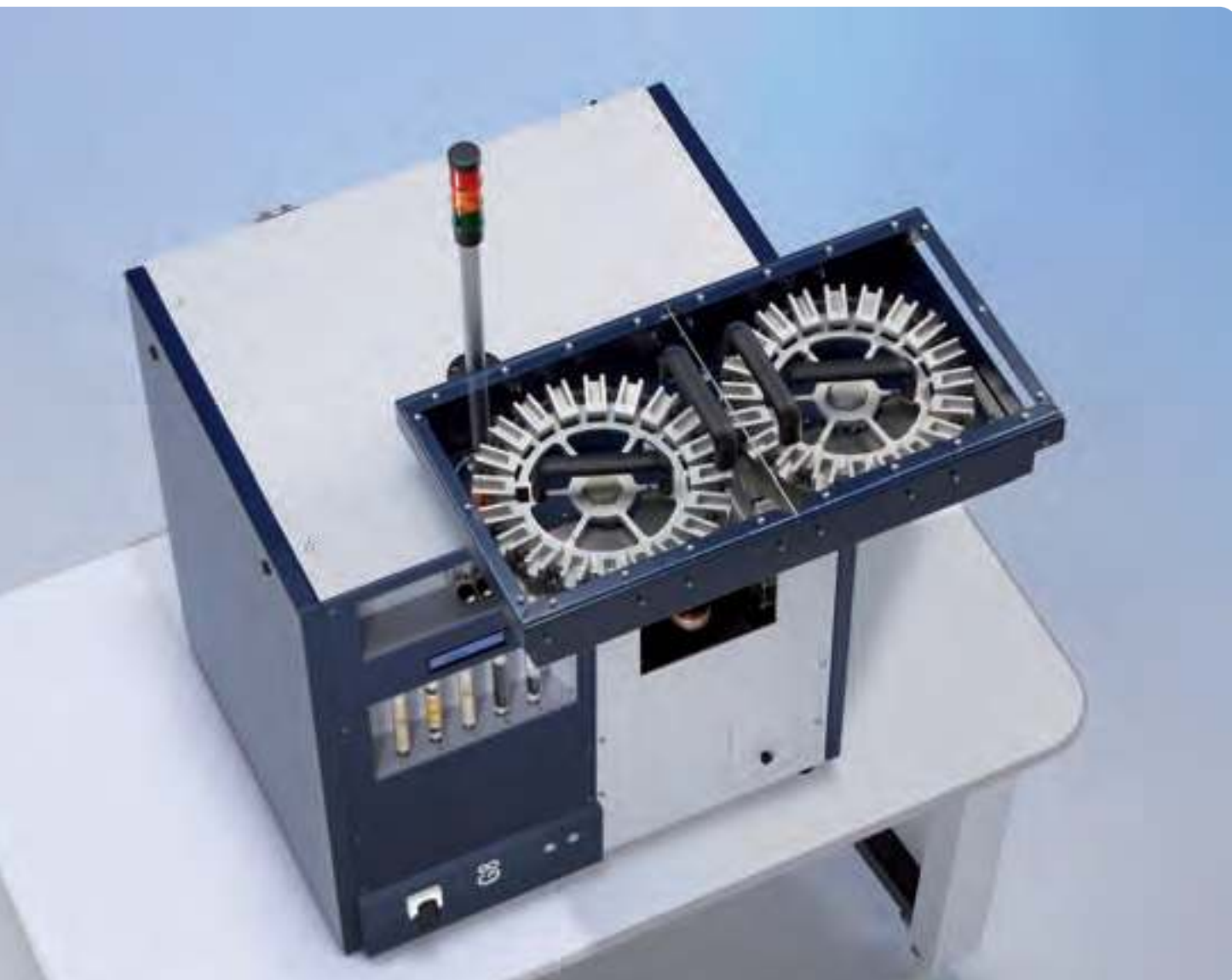
G8 GALILEO с автозагрузчиком образцов на 40 позиций для ONH анализа @ высокая производительность
