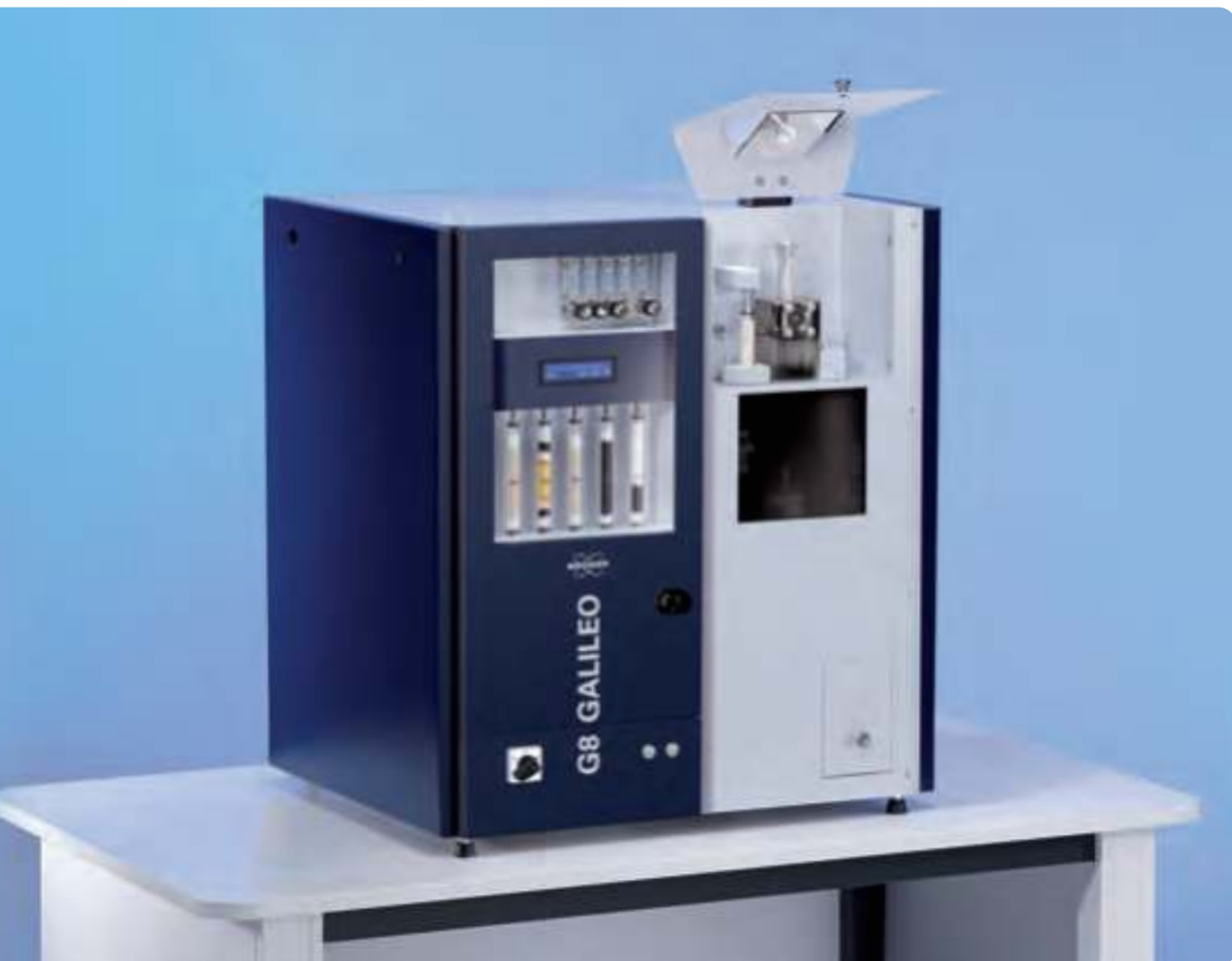
G8 GALILEO – для прямого измерения газов – кислорода, азота и водорода
