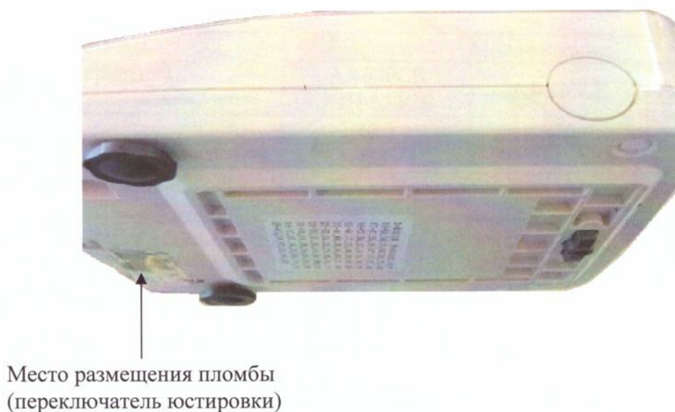
Рисунок 2 - Схема пломбировки весов от несанкционированного доступа
