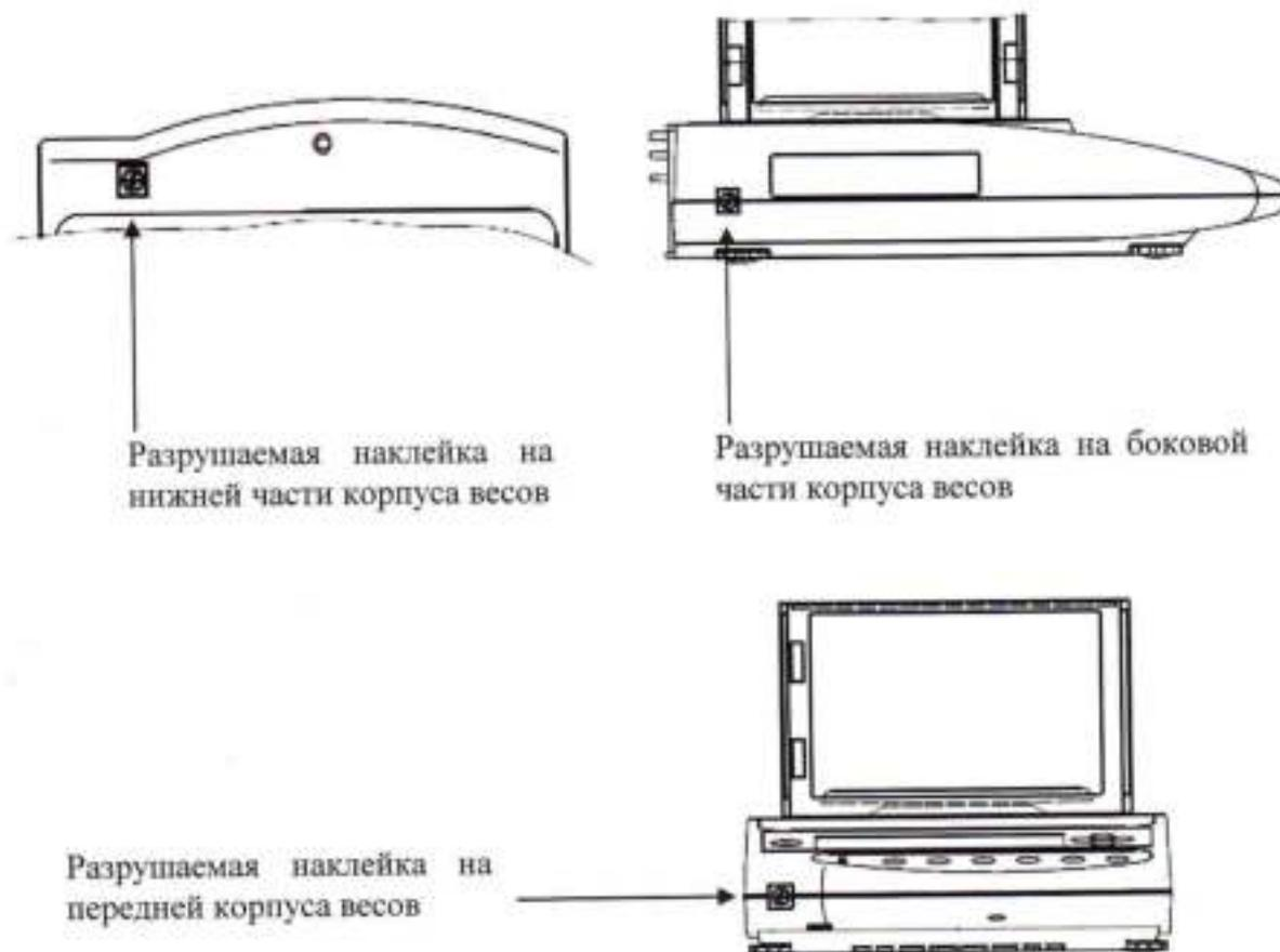
Рисунок 2 - Схема пломбировки весов от несанкционированного доступа
