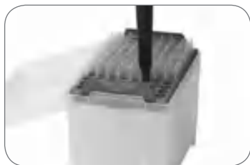
Присоединяйте наконечник к дозатору аккуратно, пользуясь преимуществами механизма Optiload для присоединения наконечников
