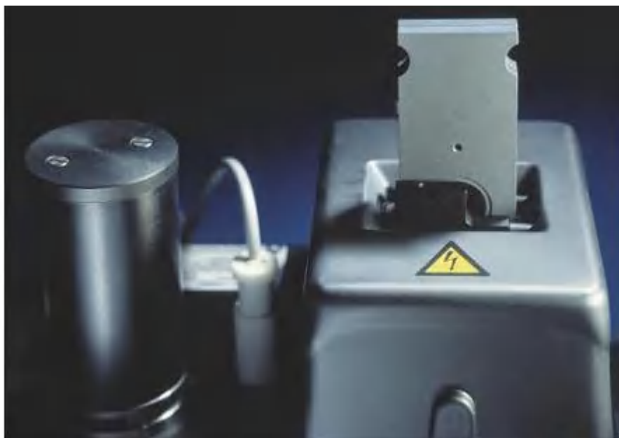
Блок полировки с насосом электролита, электронным термометром и заменяемыми держателями образцов.
