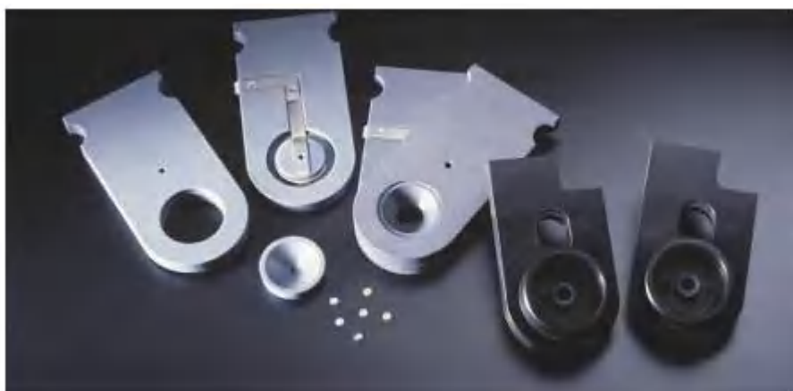
Держатель для образцов диаметром 3 мм, предназначенный для финального утонения, диаметром 10 мм – для предварительного утонения или электролитической перфорации, а также набор держателей форсунок. На рисунке также показан платиновый проводник и съемная диафрагма для образца.
