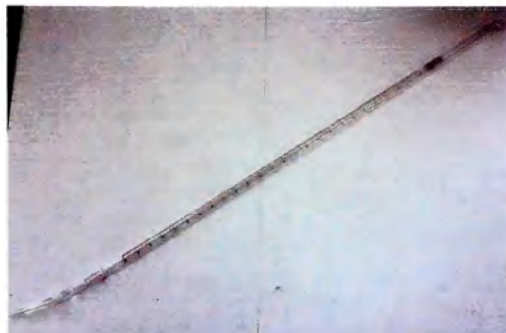
Рисунок 2 - Общий вид бюретки без установленного времени ожидания и без крана тип 1 исполнение 3
