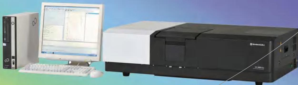
Три детектора обеспечивают высокую чувствительность прибора при измерении малых и больших, жидких и твердых образцов в диапазоне от УФ до ближнего ИК
