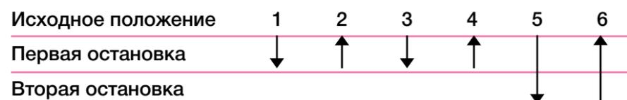
«Да»: При невозможности предварительного ополаскивания наконечника жидкостью и необходимости перенесения образца полностью для правильного проведения анализа.
