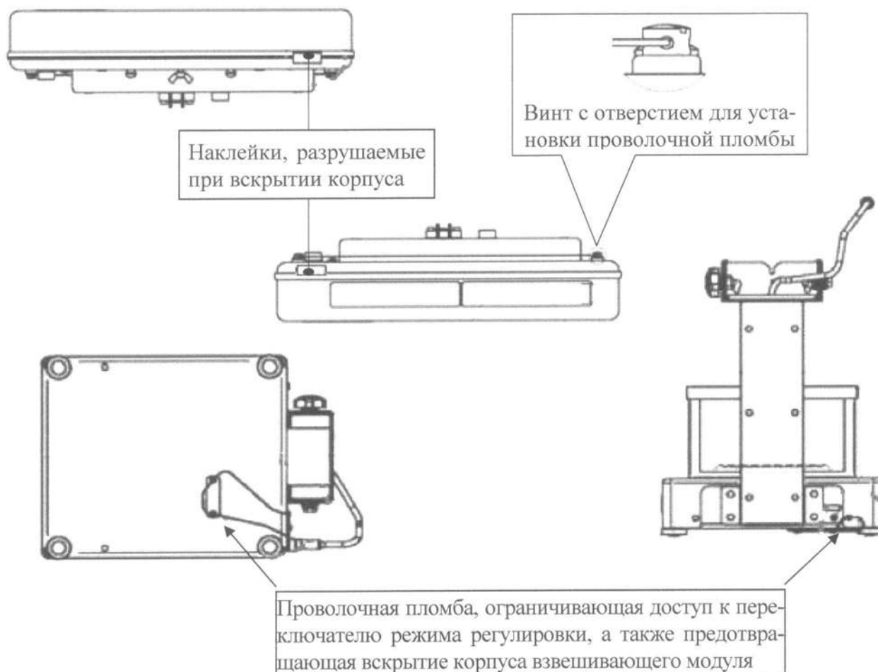
Рисунок 2 - Схема пломбировки от несанкционированного доступа
