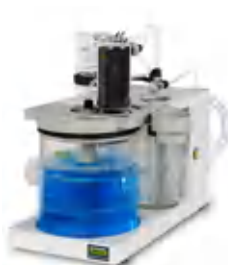
Scrubber К-415 Нейтрализация
