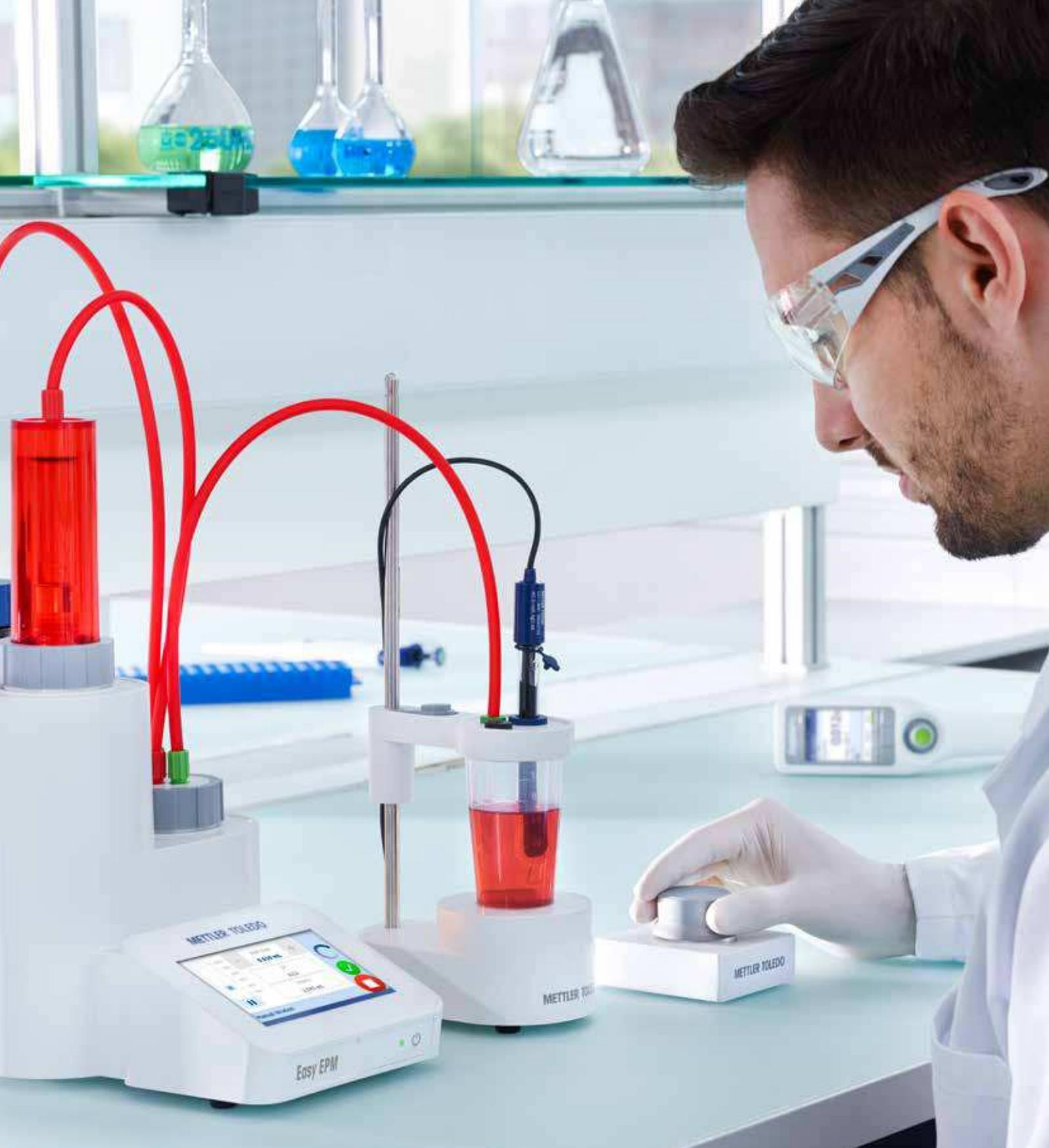
Уровень pH и кислотность являются важными параметрами контроля качества различных продуктов. С какими бы материалами ни приходилось работать — от молока и апельсинового сока до масел и смазочных материалов — Easy EPM будет правильным выбором. Датчик pH позволяет упростить процесс ручного титрования и свести к минимуму риск перетитрования. Кроме того, его можно использовать непосредственно для измерения pH.
