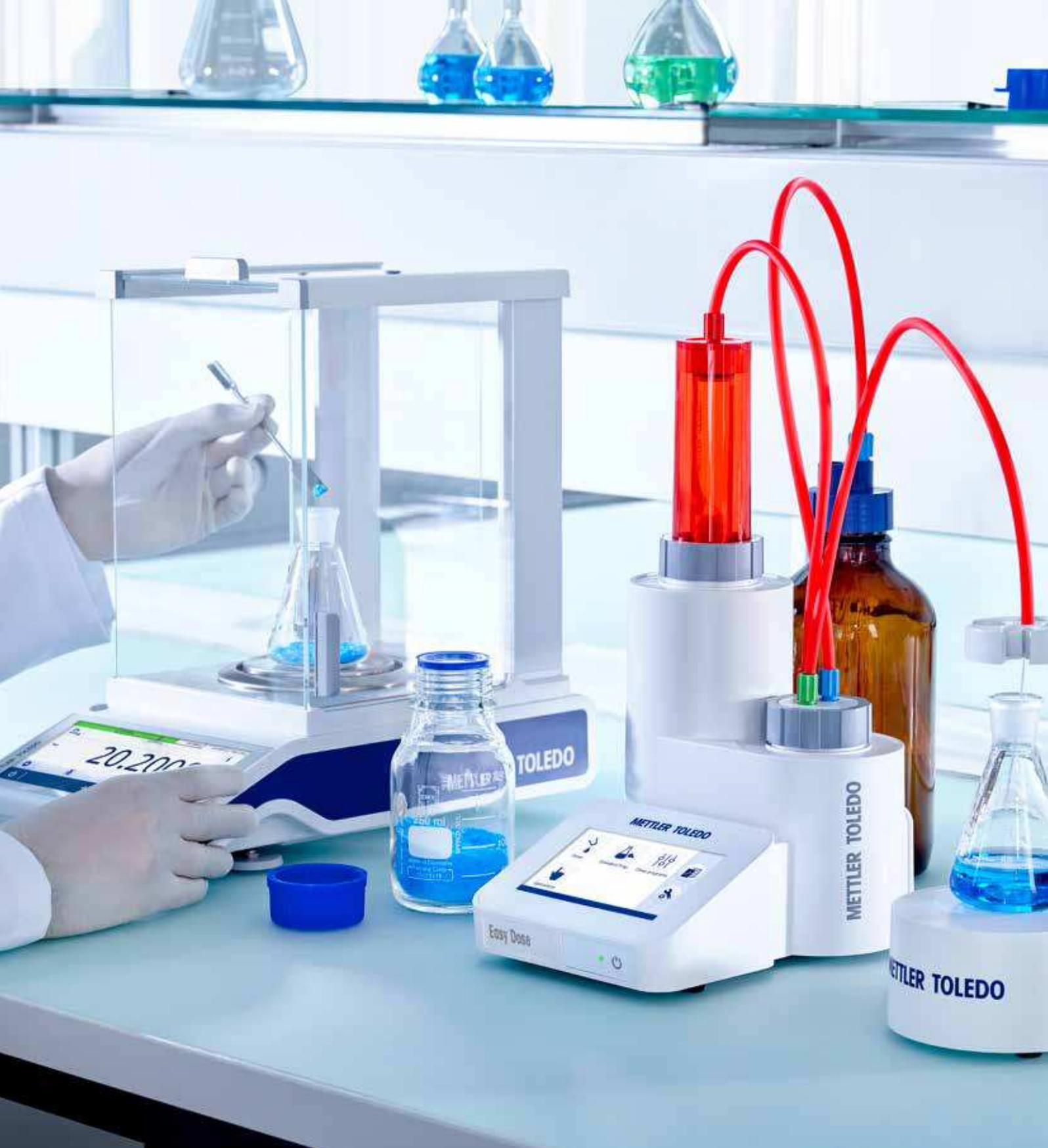
Минимизировать риск ошибок регистрации данных позволяет функция автоматической передачи данных при подключении прибора к весам MS, ML или ME компании МЕТТЛЕР ТОЛЕДО.
