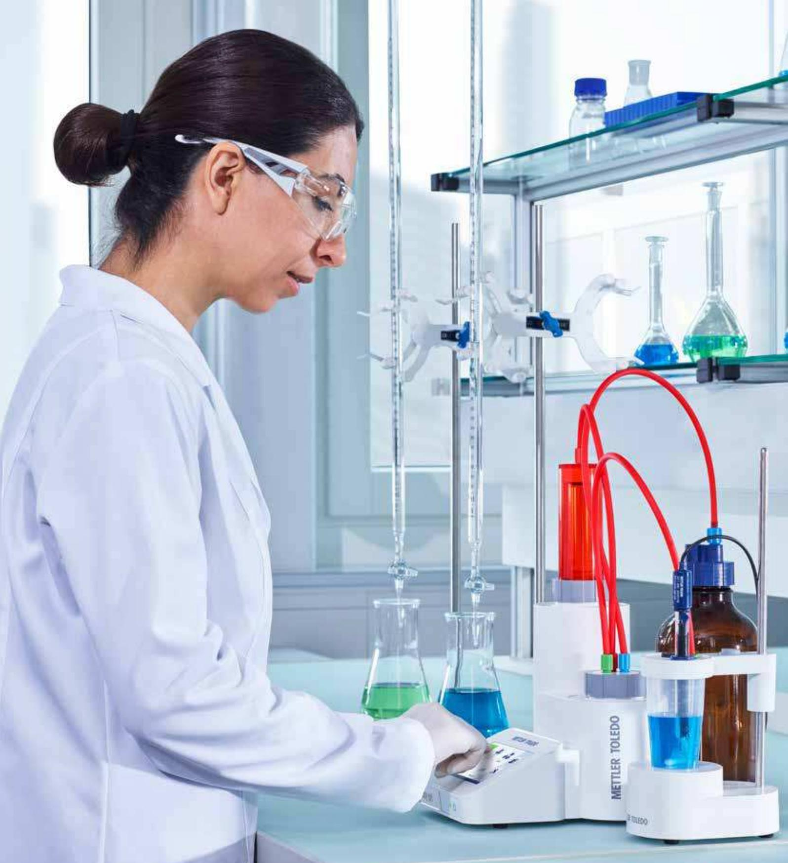
Сокращение расхода химикатов и образцов важно для любой лаборатории. Титрование автоматической бюреткой требует меньшего объема образца и, следовательно, меньше титранта.
