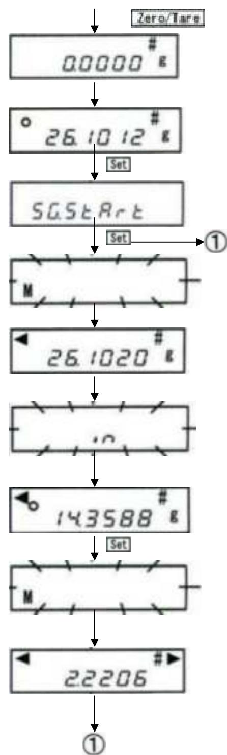
4.10 На дисплее в течение нескольких секунд будет показано сообщение [ H. StArt ], означающее начало измерения плотности жидкости. Замените в емкости жидкость известной плотности на жидкость, плотность которой нужно определить.
