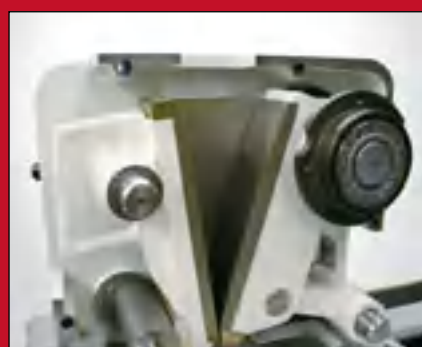
Вид камеры дробления при снятом корпусе.
