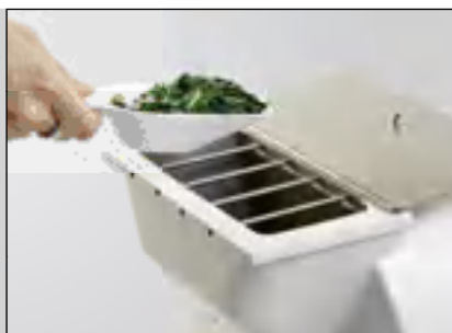
Наполнение воронки предварительно размельченными стеклянными бутылками
