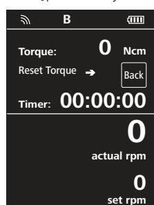
Obrócić „pokrętło-przycisk” (B, patrz **Fig. 1**) do wymaganej prędkości obrotowej. Aby uruchomić, naciśnąć „pokrętło-przycisk” (B).
