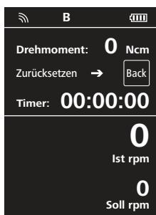
Drehen Sie den "Druck- und Drehknopf" (**B**, siehe **Fig. 1**) zu Solldrehzahl. Zum Starten drücken Sie den "Druck- und Drehknopf" (**B**).
