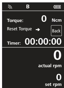
Otoče „Stiskací a otočný knoflík“ (B, viz Fig. 1) na hodnotu požadovaných otáček. Stisknutím „Stiskacího a otočného knoflíku“ (B) uveděte přístroj do chodu.
