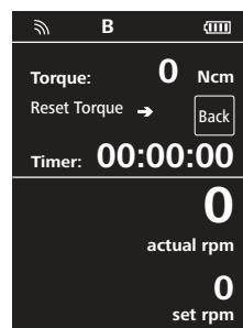
Выберите заданную частоту вращения с помощью поворотно-нажимной ручки (B, см. **Fig. 1**). Для запуска нажмите поворотно-нажимную ручку (B).
