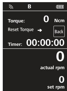
Forgassa a "Nyomó- és forgatógombot" (B, lásd **Fig. 1**) az előírt fordulatszámra! Az indításhoz nyomja meg a "Nyomó- és forgatógombot" (B)!
