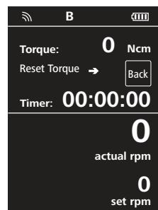
Gire el "pulsador giratorio" (B, véase **Fig. 1**) para ajustar la velocidad nominal. Para arrancar, presione el "pulsador giratorio" (B).
