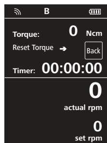
Käännä paine- ja säätönupbia (B, katsot **Fig. 1**) pyörimisnopeuden asetusarvoon. Käynnistä painamalla paine- ja säätönupbia (B).
