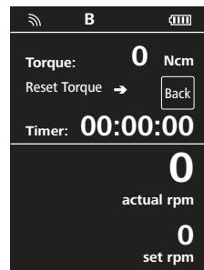
Rotiți „butonul rotativ și de apăsare” (B, consultați **Fig. 1**) până la turația nominală. Pentru pornire, apăsați butonul „rotativ și de apăsare” (B).
