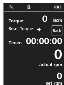
旋转旋/按钮(B, 见 Fig. 1)设置目标转速; 按下旋/按钮(B)搅拌器以所设定的转速开始运转。
