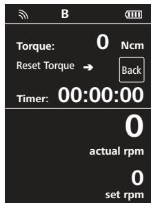
Drej "tryk- og drejeknappen" (B, se **Fig. 1**) til det nominelle omdrejningstal. For at starte tryk på "tryk- og drejeknappen" (B).
