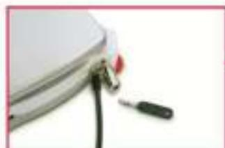
**Гнездо для защитного устройства**
