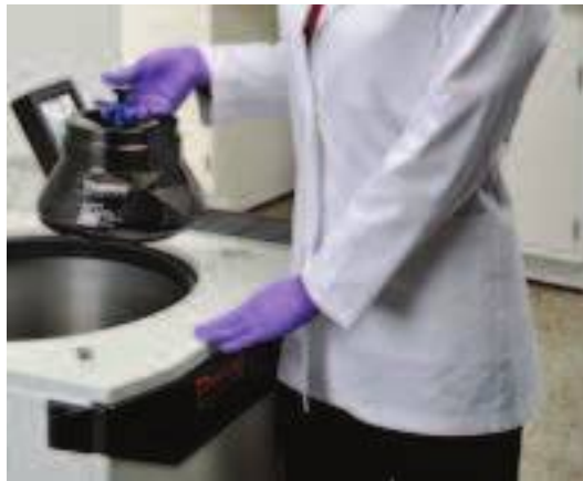
Облегченный ротор с ручкой-блокиратором
