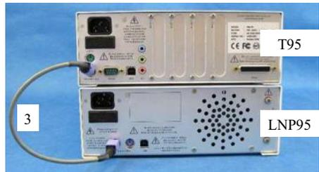
**LNP95 MUST BE SWITCHED ON BEFORE T95 SYSTEM CONTROLLER**
