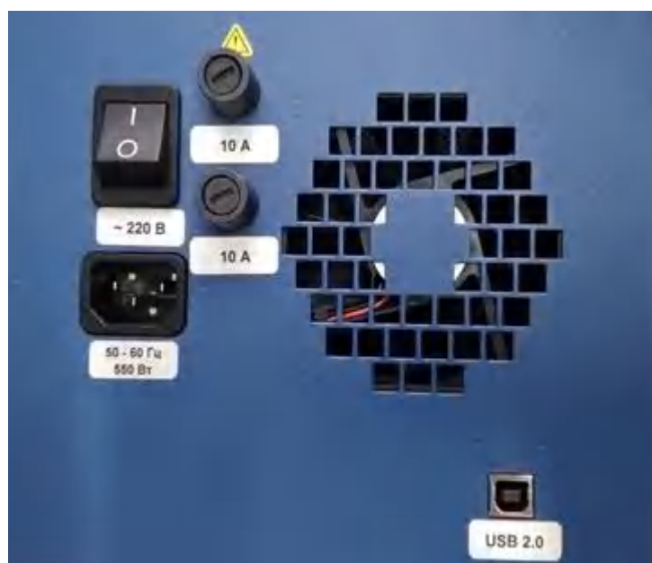
Рис.3. Расположение разъемов на задней панели прибора
