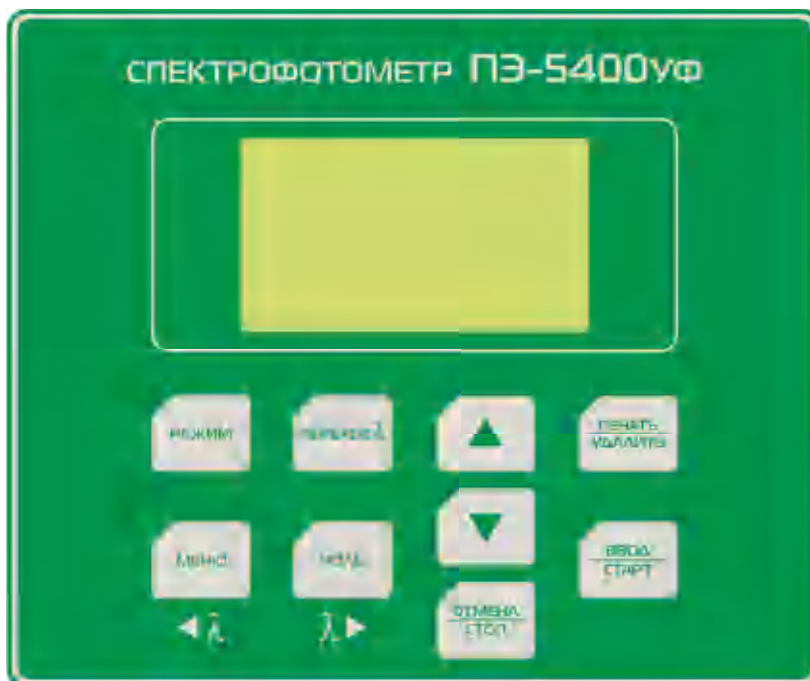
Рисунок 4 - Панель управления спектрофотометра ПЭ-5400УФ.
