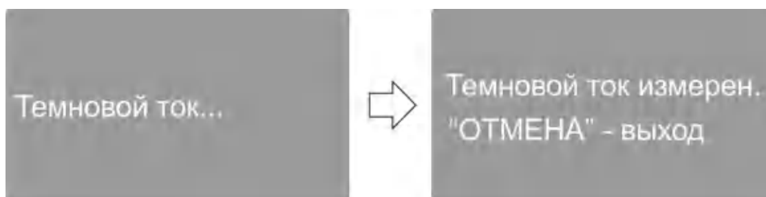
Рисунок 20 - Компенсация темнового тока.
