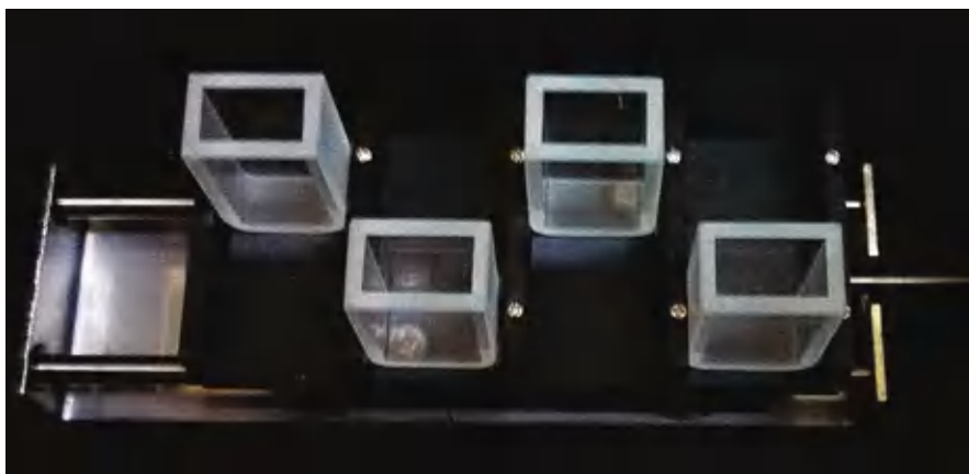
Рисунок 2 - Установка кювет в шахматном порядке.
