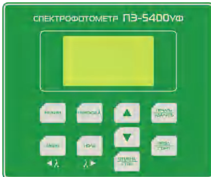
Рисунок 4 - Панель управления спектрофотометра ПЭ-5400УФ.
