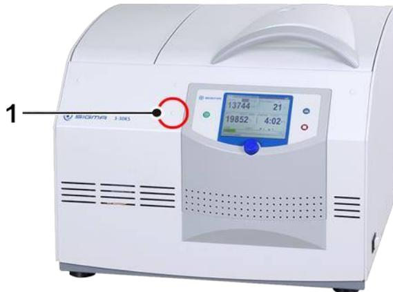
Abb. 30: Position der Öffnung für die Notentriegelung
