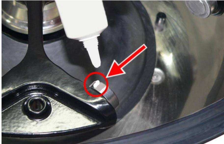
Abb. 32: ausreichende Menge Tragbolzenfett für einen Bolzen
