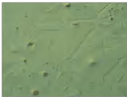
Нержавеющая сталь, 500x, дифференциально-интерференционный контраст.
