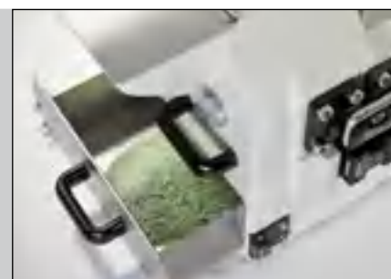
Результаты измельчения при ширине зазора 1 мм
