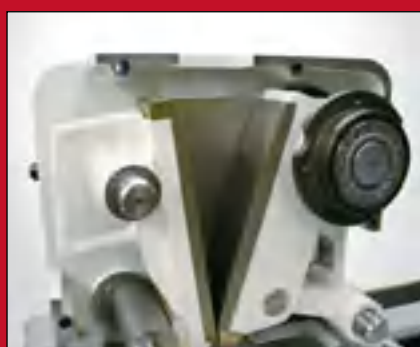
Вид камеры дробления при снятом корпусе.
