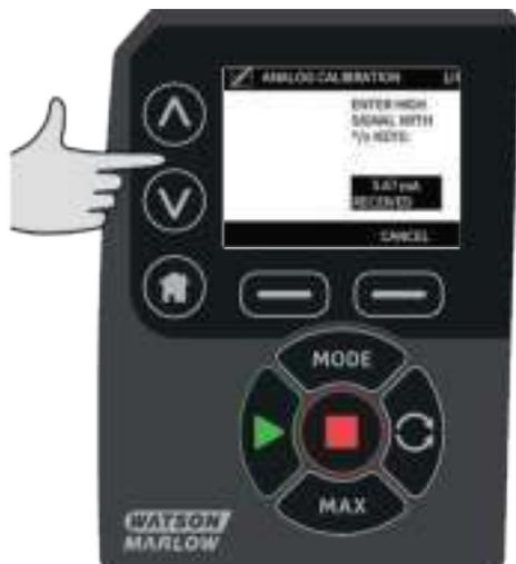
Если сигнал в миллиамперах находится в допустимых пределах, на экране появится кнопка АСЦЕПТ (Принять). Нажмите кнопку **АСЦЕПТ**, чтобы принять это значение, или кнопку **CANCEL (Отменить)**, чтобы вернуться на предыдущий экран.
