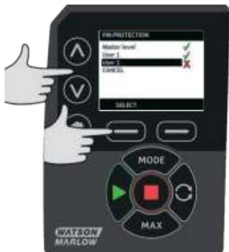
Активируйте настройки безопасности для Пользователя 2. Откроется экран ввода PIN-кода для Пользователя 2. Чтобы задать четырехзначный PIN-код Пользователя 2, кнопками  $\wedge$  /  $\vee$  выберите каждую цифру от 0 до 9. Установив нужную цифру, нажмите кнопку **NEXT DIGIT (следующая цифра)**. Выбрав все четыре цифры, нажмите **ENTER**.
