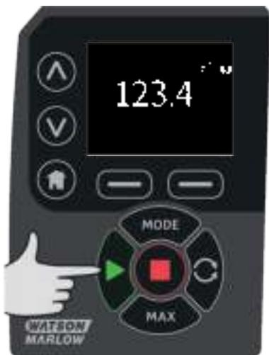
При нажатии этой кнопки насос запускается на скорости, которая высвечивается на экране. Цвет фона дисплея становится серым. Если насос уже работает, нажатие этой кнопки ничего не дает.
