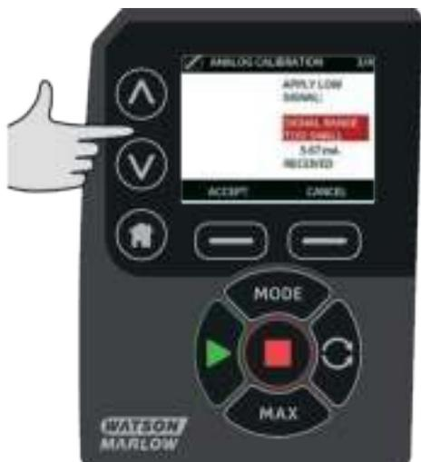
Если низкий сигнал в миллиамперах находится в допустимых пределах, на экране появится кнопка АССЕРТ (Принять). Нажмите кнопку **АССЕРТ**, чтобы принять значение низкого сигнала, или кнопку **САНСЕЛ (Отменить)**, чтобы вернуться на предыдущий экран.
