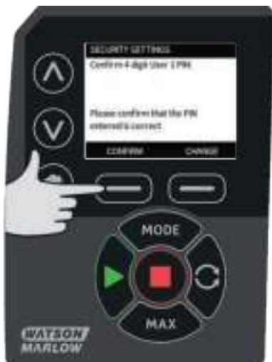
Чтобы определить доступные пользователю функции, клавишами  $\wedge$  /  $\vee$  выбирайте функции и нажимайте **ENABLE (Разрешить)**. PIN-код Пользователя 1 позволит получить доступ только к «разрешенным» функциям. Чтобы запретить доступ к разрешенной ранее функции, выберите ее в списке и нажмите **DISABLE (запретить)**. Разрешив все необходимые функции, нажмите **FINISH (закончить)**.
