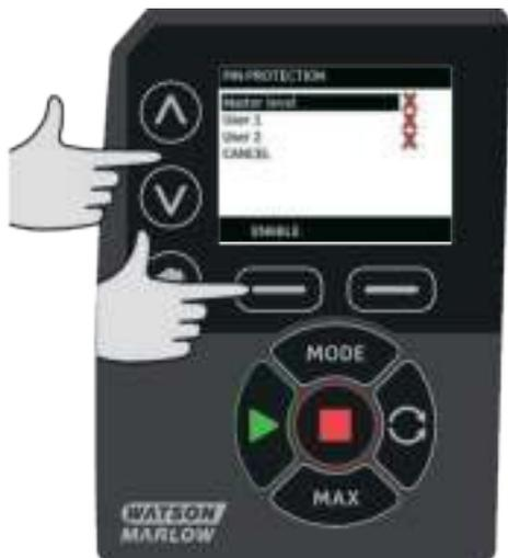
Чтобы задать четырехзначный PIN-код, кнопками  $\wedge$  /  $\vee$  выберите каждую цифру от 0 до 9. Установив нужную цифру, нажмите кнопку **NEXT DIGIT (следующая цифра)**. Выбрав все четыре цифры, нажмите **ENTER**.
