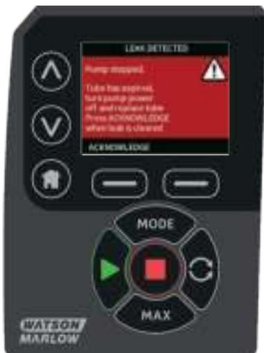
Выполните инструкции, приведенные в главе "Замена трубки " на странице 115, и замените трубку или трубочный элемент.
