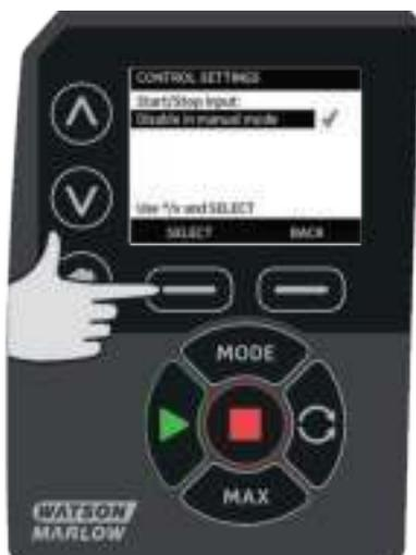
Кнопками  $\wedge$  /  $\vee$  выберите логическое состояние данного входа для подключенного управляющего устройства и нажмите **SELECT**.
