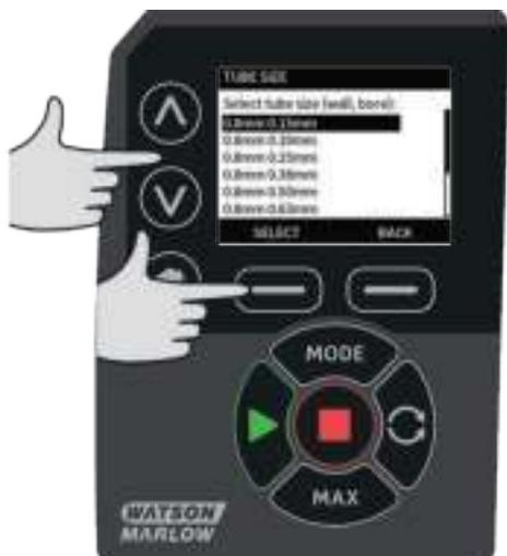
Если был выбран элемент LoadSure, размер трубки отображается в виде давления и внутреннего диаметра.
