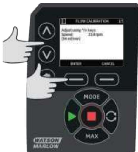
Нажмите **START**, чтобы начать перекачивание объема жидкости, необходимого для калибровки.
