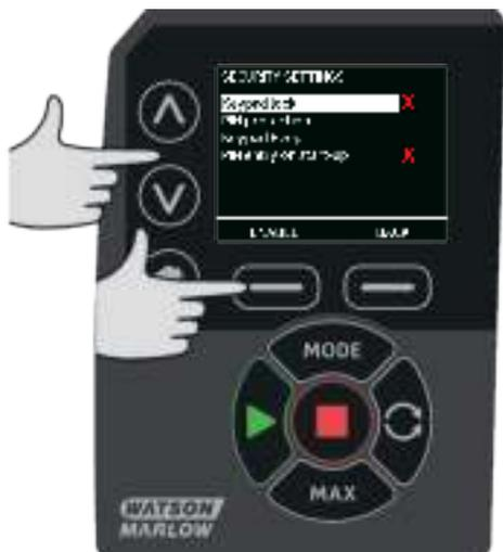
После того, как клавиатура была заблокирована, при нажатии любой клавиши на дисплее отображается следующий экран. Чтобы разблокировать клавиатуру, нажмите одновременно обе клавиши разблокировки (**UNLOCK**).
