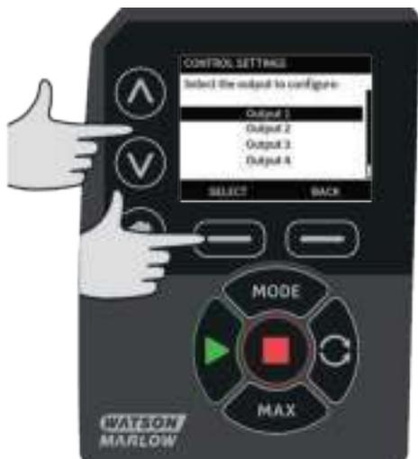
Кнопками  $\wedge$  /  $\vee$  выберите состояние насоса, которое вы хотите назначить на данный выход, и нажмите **SELECT**. Выбранный пункт отмечен галочкой.
