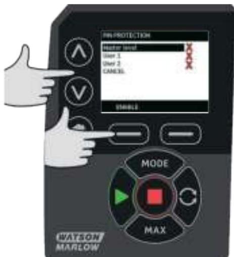
Активируйте настройки безопасности для Пользователя 1. Откроется экран ввода PIN-кода для Пользователя 1. Чтобы задать четырехзначный PIN-код Пользователя 1, кнопками  $\wedge$  /  $\vee$  выберите каждую цифру от 0 до 9. Установив нужную цифру, нажмите кнопку **NEXT DIGIT (следующая цифра)**. Выбрав все четыре цифры, нажмите **ENTER**.
