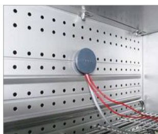
Порт доступа с силиконовыми заглушками
