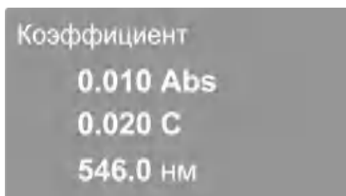
Рисунок 18 - Измерение с расчётом концентрации по коэффициентам.
