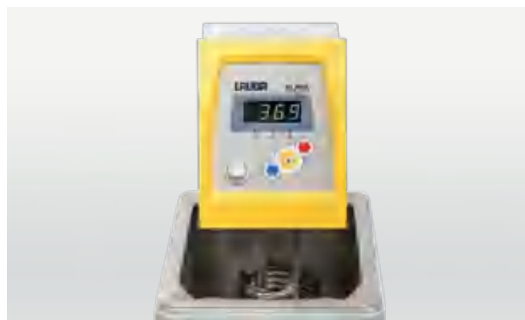
Простая и интуитивная навигация по меню посредством 3-кнопочного управления с большой и четкой светодиодной индикацией
