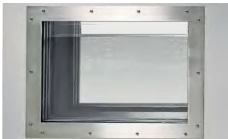
Изоляционное стекло позволяет наблюдать за образцами даже при низких температурах
