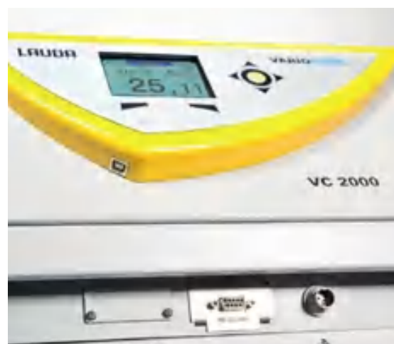
Интерфейс USB и контакт сигнала тревоги в стандартной комплектации, а также другие интерфейсы для дополнительного оснащения
