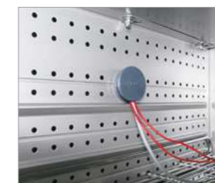
Порт доступа с силиконовыми заглушками
