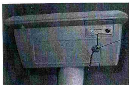
Рисунок 2 - Схема пломбировки весов.
