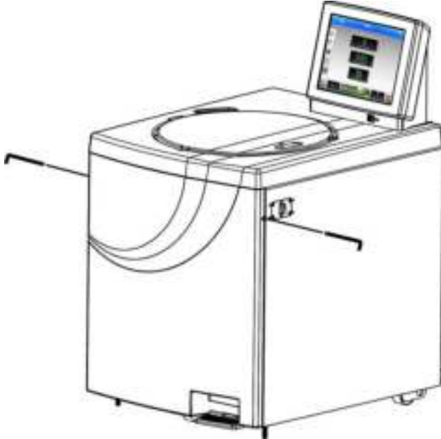
Рисунок 7.2 Доступ к защелкам для высвобождения крышки в аварийной ситуации
