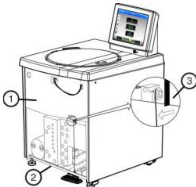
Рисунок 7.3 Разблокировка крышки вручную
