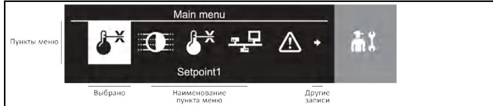
При одновременном нажатии обеих >кнопок со стрелками< [B] вызывается главное меню. В зависимости от оснащения используемого термостата некоторые пункты меню невозможno выбрать.
