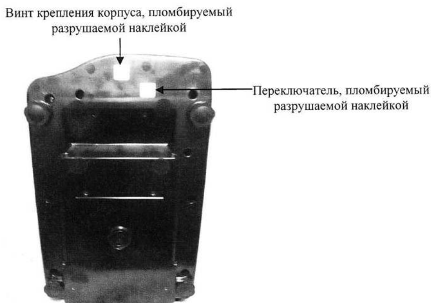
Рисунок 2 - Схема пломбировки весов от несанкционированного доступа.
