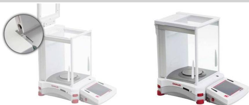
2 Установка грузоприемной платформы (Более детальная информация изложена на 10 странице инструкции по эксплуатации)
