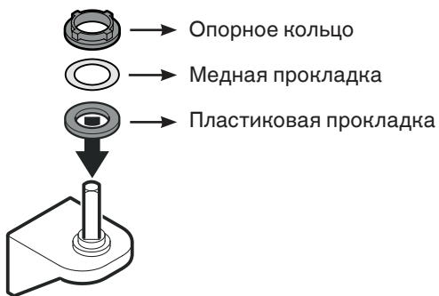
19. Наденьте все части опоры на шарнирный уголок.
