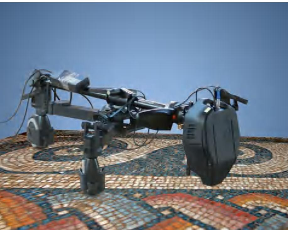
ELIO – это компактный портативный энергодисперсионный рентгенофлуоресцентный спектрометр для быстрого, бесконтактного и неразрушающего элементного анализа материалов, представляющих собой высокую культурную ценность. Спектрометр обеспечивает высокую производительность и точность даже при решении сложных задач элементного анализа.
