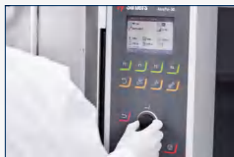
Удобное управление Благодаря многоцелевой поворотной-нажимной кнопке, навигация по меню станка осуществляется просто и быстро.
