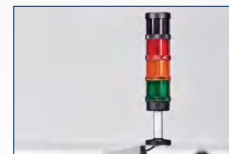
Отображение состояния рабочего процесса Маяк помогает оператору уделять внимание станку только когда это необходимо.
