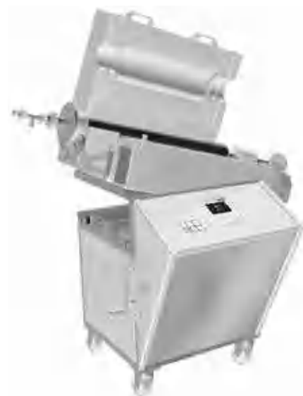
Вращающаяся трубчатая печь, наклоненная вправо для заполнения и работы в периодическом режиме производства
