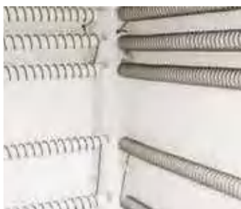
Исполнение в виде модели LF для меньших сроков нагрева и охлаждения
