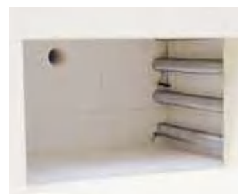
Внутреннее пространство печи с высококачественной изоляцией огнеупорным легковесным кирпичом
