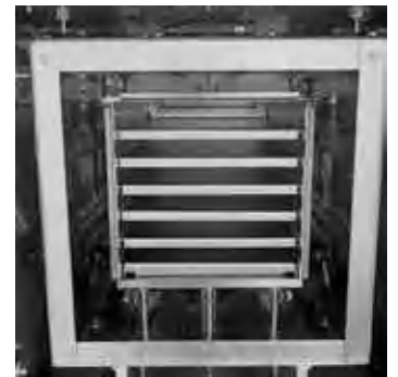
Молибденовый цементационный ящик с шестью подставками для загрузки
