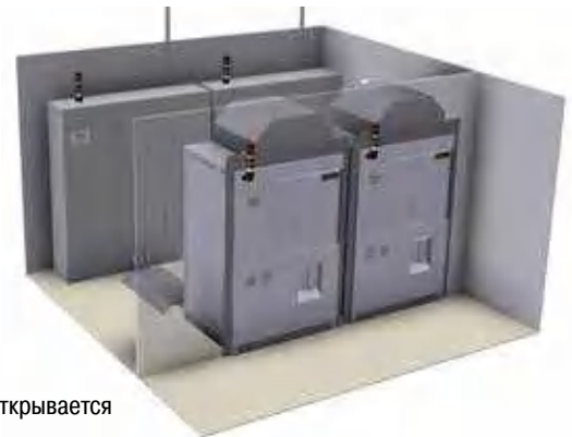
Высокотемпературная печь с загрузкой из чистого помещения; переключающее устройство и печь в сером помещении
