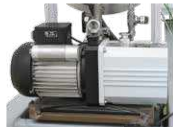
Вакуумный насос для холодного вакуумирования реторты
