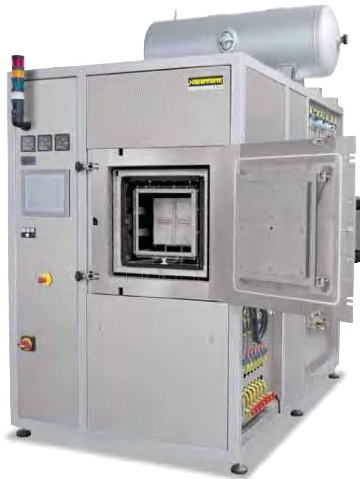
Ретортная печь VHT 40/16-MO H 2 с расширительным пакетом для работы в водородной среде и технологическим загрузочным бункером
