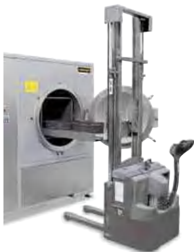
Загрузка ретортной печи NRA 300/06 с помощью автопогрузчика
