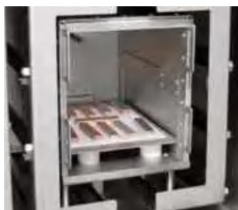
Тепловая обработка медных стержней в водороде в ретортной печи VHT 8/16-MO
