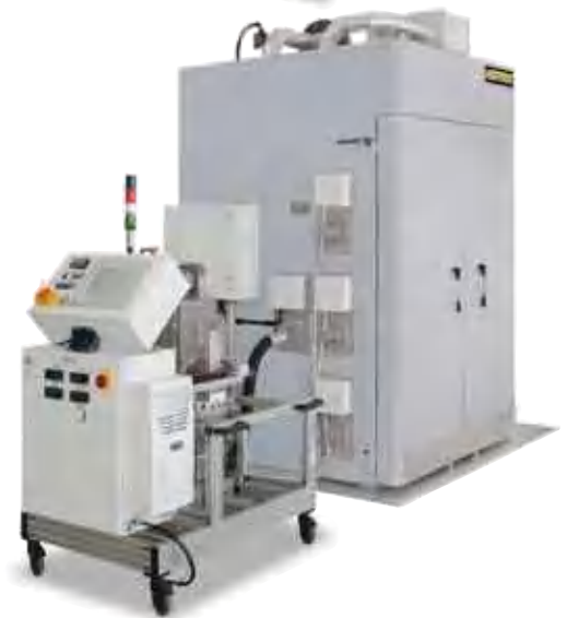
KTR 3100/S для затвердевания многослойных волокнистых материалов в вакуумных мешках, вкл. насос и необходимые соединения в пространстве печи
