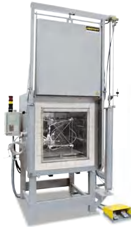
Измерительная рама для определения однородности температуры
