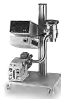
Каркас вакуумного насоса для работы до 10^{-5} мбар
