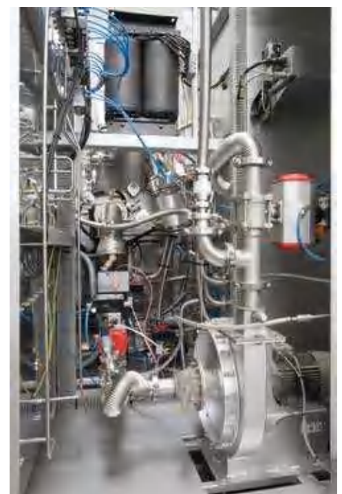
Быстрое охлаждение газом ретортной печи с холодной стенкой VHT 8/16-MO
