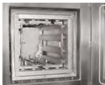
Молибденовый или вольфрамовый нагревательный элемент
