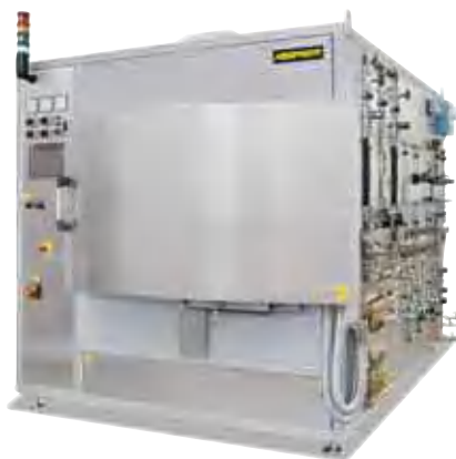
Ретортная печь NRA 300/09 H 2 для тепловой обработки в водородной среде
