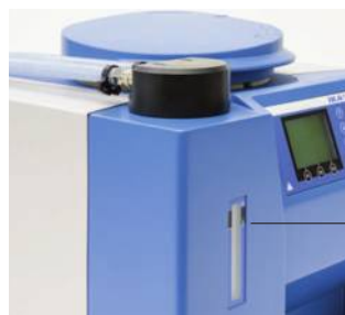
Maks. poziom napełnienia na wskaźniku poziomu napełnienia
