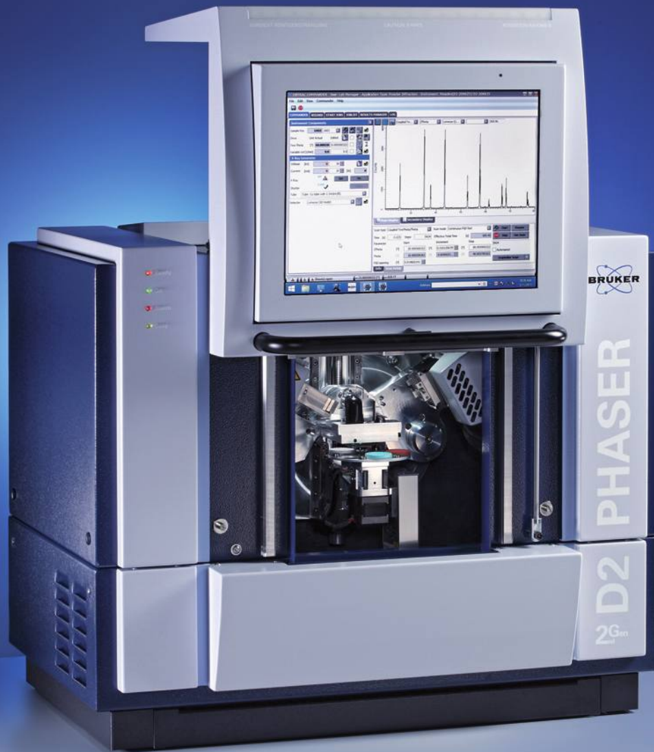
Прибор D2 PHASER: сдвижная передняя крышка позволяет загружать образцы, не отключая монитор
