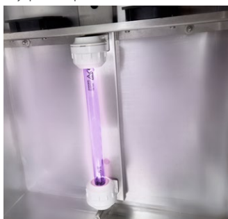
Система УФ-рециркуляции воздуха внутри камеры
