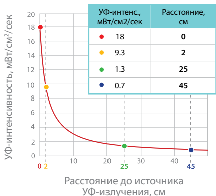
Рис. 1.1. Падение интенсивности УФ в зависимости от расстояния до поверхности источника УФ
