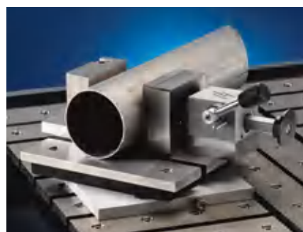
Поворотный столик с Т-образным пазом для резания под углом и с зажимами для круглых заготовок.
