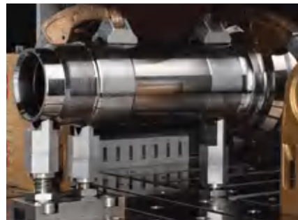
Регулируемые опорные стойки (поворотные, регулируемые по горизонтали и вертикали) и вертикальные зажимные устройства (опция – расширяющий рычаг).
