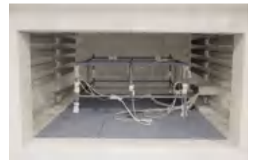
Измерительное устройство в печи для отжига
