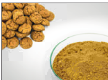
Печенье и таблетки до и после измельчения на ножевой мельнице PULVERISETTE 11
