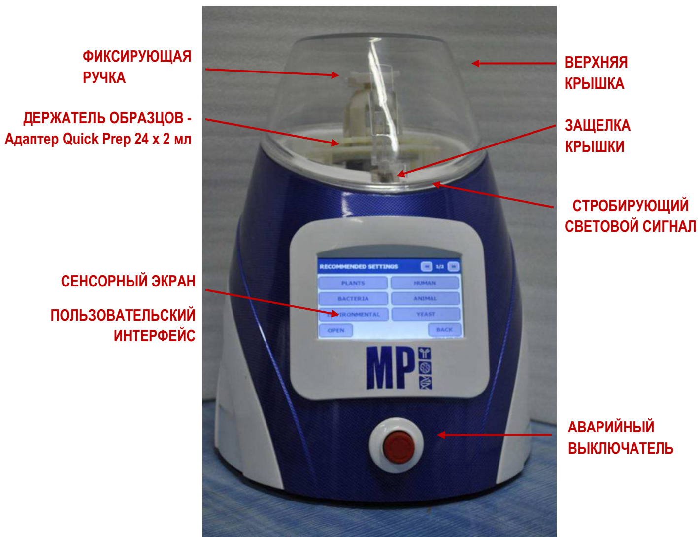
Рисунок I-1: Основные компоненты FastPrep -24 5G (вид передней панели)
