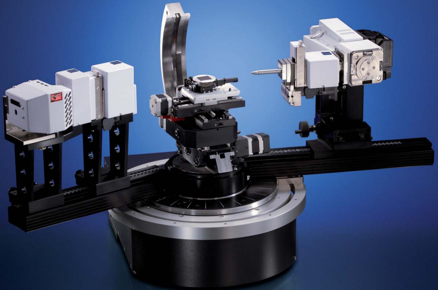
In-plane конфигурация с подвеской Эйлера и держателем с независимыми наклонами
