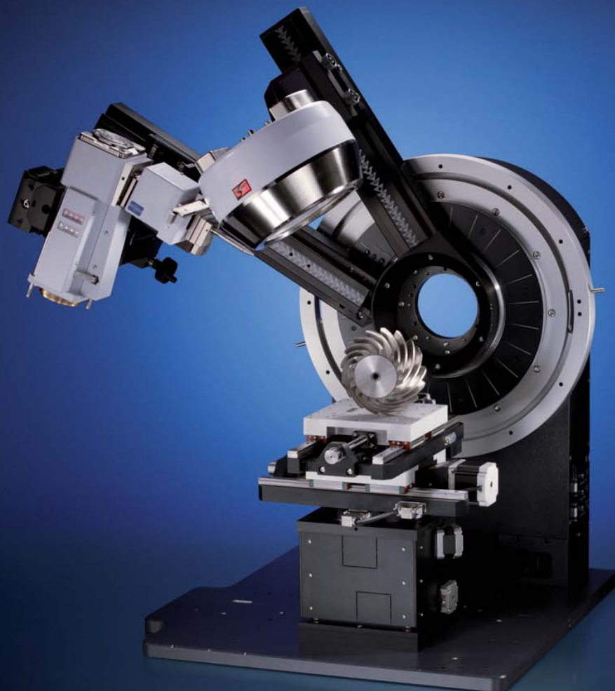
Конфигурация для анализа остаточных напряжений, включающая детектор VANTEC-500 и UMC держатель образцов с весом до 50 кг
