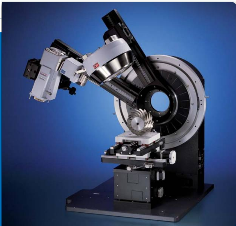
Конфигурация с вертикальным гониометром, UMC держателем и детектором VANTEC-500 для измерения остаточных напряжений
