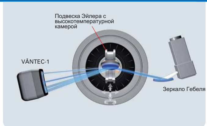
Конфигурация для измерения в нестандартных условиях с температурной камерой купольного типа DHS1100 и детектором VANTEC-1
