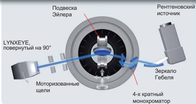
HRXRD конфигурация с 4-х кратным монохроматором
