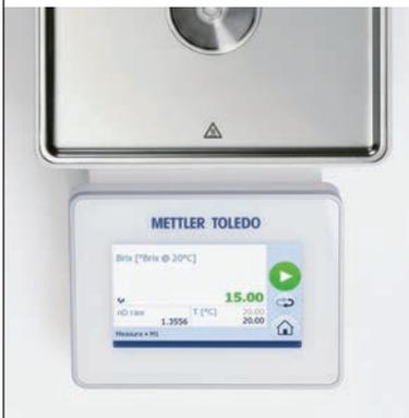
Настроив диапазон допустимых пределов, можно упростить стандартные измерения и мгновенно определять, какие образцы соответствуют требованиям. Цветовая кодировка результатов позволяет быстро установить, находится ли измерение в допустимых пределах.
