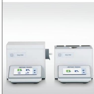
Приборы имеют встроенную систему контроля температуры, что позволяет получать более точные результаты. Встроенный элемент Пельтье быстро нагревает или охлаждает измерительную ячейку, позволяя выполнять анализы при нужной температуре.
