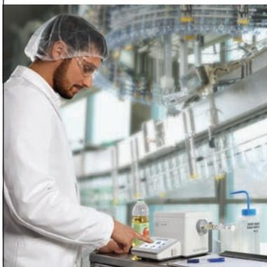
Измеряйте плотность вблизи производственной линии: новая конструкция измерительной ячейки минимизирует влияние внешних механических колебаний и позволяет получать точные результаты даже в нестабильных условиях.
