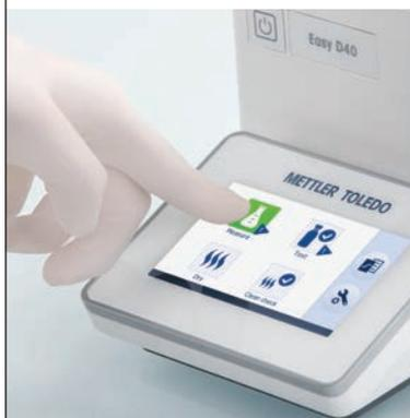
Технология LongClick предельно упрощает измерения. Одного длинного нажатия на ярлык достаточно, чтобы запустить обычный анализ и получить результат за считанные секунды.
