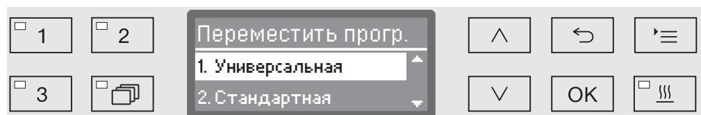
В списке программ есть все разрешенные для применения программы (см. главу «Расширенные указания/Разрешение применения программы»). Решающим для назначения кнопок выбора программ является положение в списке программ. Программы в списке пронумерованы от 1. Первые три программы закреплены за кнопками выбора программ, например:
