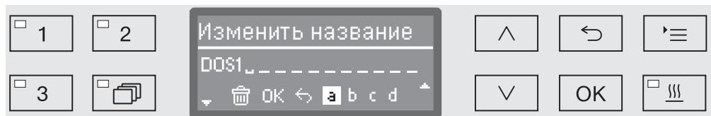
В средней строке отображается текущее название. Его можно будет обработать с помощью опций из нижней строки. В верхней строке отображается выбранная опция из нижней строки.
