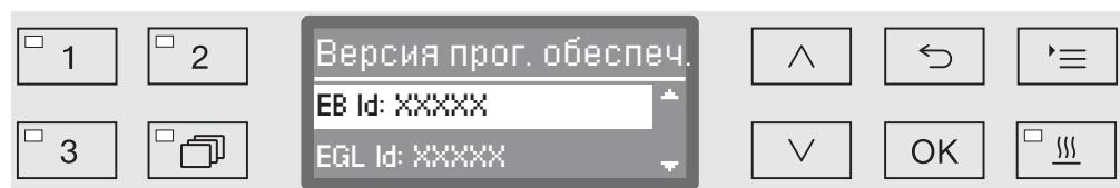
После этого на дисплее отобразится список блоков программного обеспечения, где XXXXX является соответствующим номером версии:
