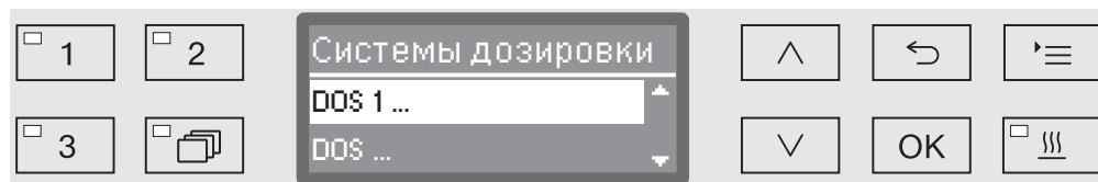
Количество дозирующих систем может варьироваться в зависимости от оснащения прибора и подключенных DOS-модулей.
