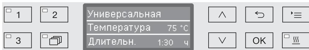
Загорится светодиод выбранной кнопки, а на дисплее отобразится соответствующая программа. Также начнёт мигать светодиод кнопки *Start/Stop* (Старт/Стоп).
