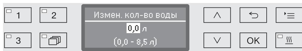
Расход воды можно повышать или снова снижать с шагом 0,5 л. В самой нижней строке приводится диапазон возможных установок. Установка «0 литров» соответствует расходу, приводимому в таблице программы.
