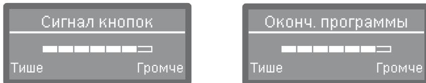
Уровень громкости отображается с помощью сегментной шкалы. При самой низкой установке сигнал зуммера выключен.
