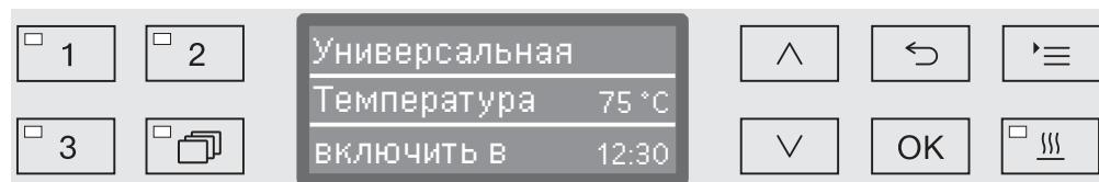
После этого на дисплее появится выбранная программа с установленным временем запуска. Если активирована функция автоматического выключения (см. главу «Расширенные указания/Отключение через»), то по истечении установленного времени автомат для мойки выключается до запуска программы.
