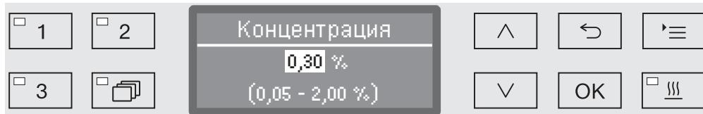
Концентрацию дозирования можно устанавливать с шагом 0,01%. В нижней строке приводится диапазон возможных установок.
