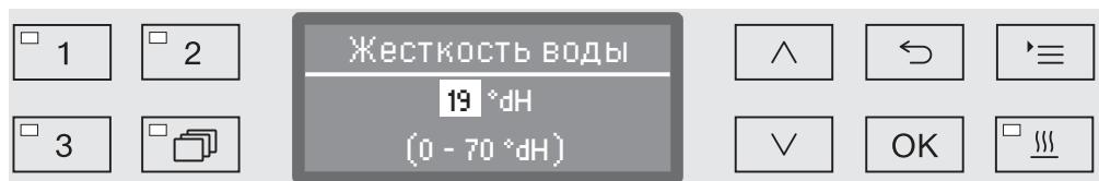
В самой нижней строке дисплея приводится диапазон возможных установок. Значения для установки жесткости воды приведены в таблице в главе «Устройство смягчения воды/Таблица установок».
