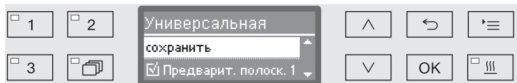
Распределение осуществляется многократным выбором. На экране дисплея перед названием каждого этапа обработки отображается клетка . Если этап обработки имеется в программе, в клетке имеется галочка . Выбором этапов обработки их можно назначить для программы или снова удалить назначение.
