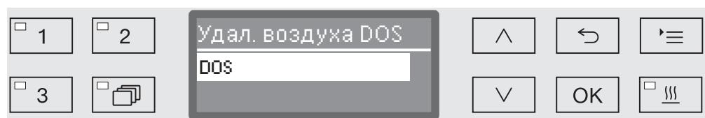
Автоматическое удаление воздуха запускается с выбором дозирующей системы. Однажды запустившийся процесс автоматического удаления воздуха уже нельзя будет прервать.
