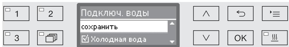
Настройка подключений воды осуществляется многократным выбором. На экране дисплея перед названиями всех подключений воды отображается клетка . Если подключение воды активировано, то в клетке стоит галочка . Выбором подключений воды их можно активировать или, соответственно, деактивировать.
